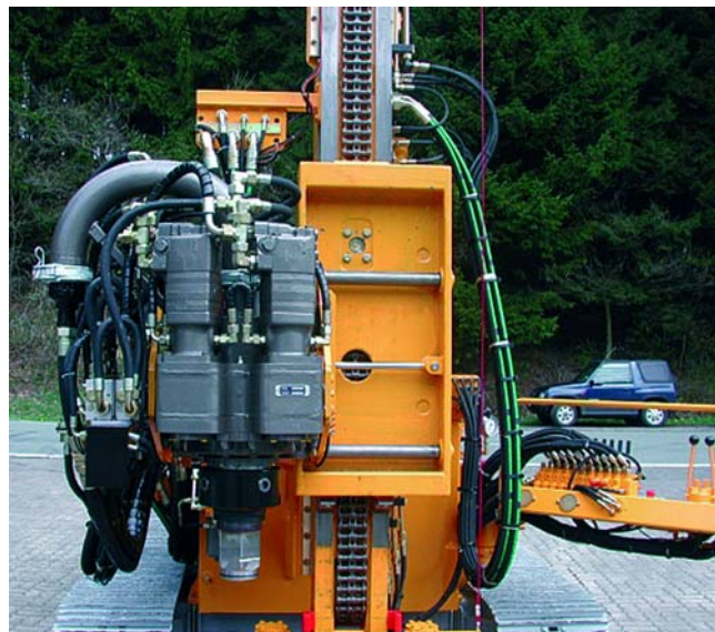
Kraftdrehkopf Typ KH 43 mit 4" Betonierkopf und Schwanenhals auf hydr. seitlich verschiebbarem Schlitten rotary head type KH 43 with 4" concrete injection head and swan neck on hydr. shiftable slide
