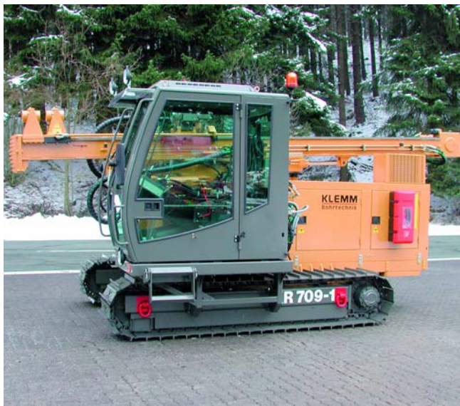
KLEMM Bohrergerät Typ KR 709-1 mit Kabine KLEMM drill rig type KR 709-1 with cabin
