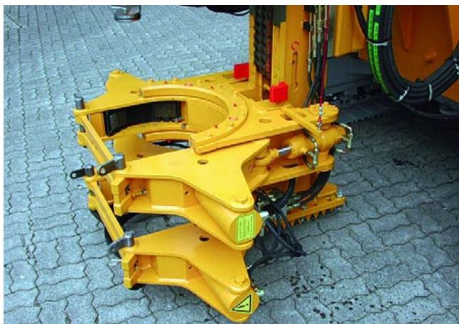
Klemm- und Brechvorrichtung Typ I, bis \varnothing 508 mm clamping and breaking device type I, for \varnothing 508 mm
