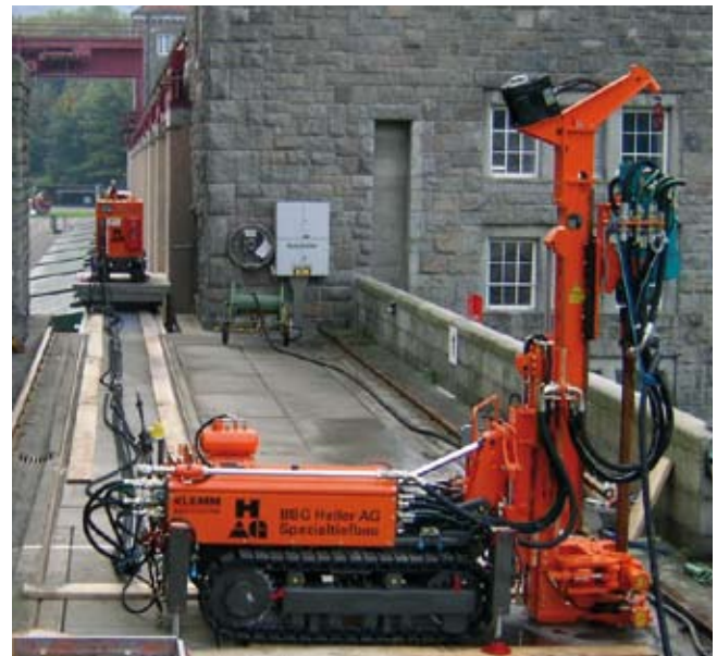
KR 702-2 Hydraulisches Bohrgerät mit Power Pack auf Raupenfahwerk Hydraulic drill rig with power pack on crawler track
